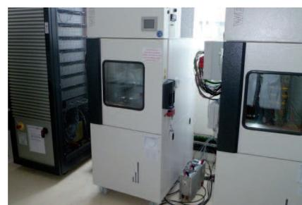
Le banc HIL batterie d'IFPEN permet d'évaluer le comportement d'une batterie au sein d'un groupe motopropulseur complexe entièrement virtuel.
