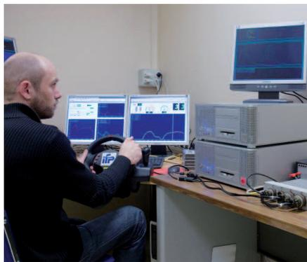
Plateforme de simulation HIL permettant de tester en temps réel les systèmes de contrôle moteur.
